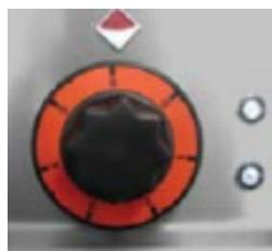
Schalten Sie den Hauptschalter ein, drehen Sie den Regler von Position "0" auf den gewünschten Wert im Bereich 1 - 6. Die Kontrollleuchte leuchtet - das Gerät ist eingeschaltet. Schalten Sie das Gerät aus, wenn Sie den Drehknopf auf die Position "0" drehen
